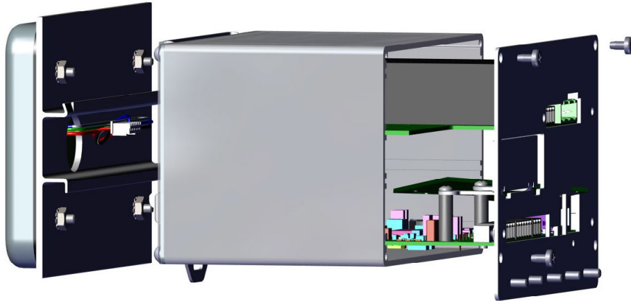
Figura 2-9. Retire la placa posterior del bloque del controlador
