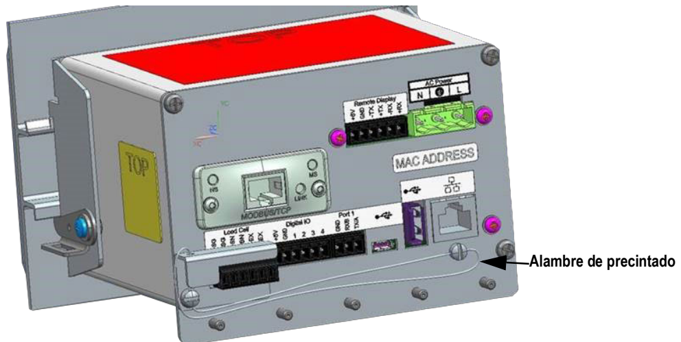
Figura 2-29. Instale el alambre de precintado
