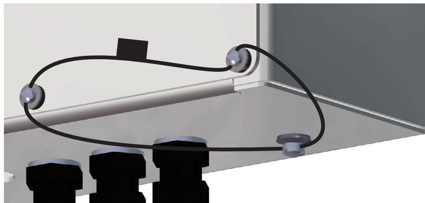
Figura 2-30. Sellado de la unidad de montaje universal
