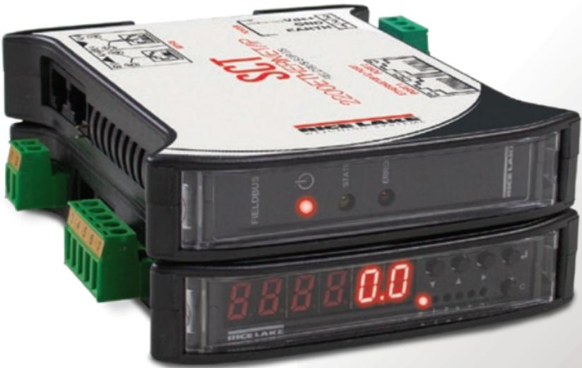
El transmisor de acondicionamiento de señales SCT-2200 ofrece el control de datos de peso para controladores PLC sin los requisitos de espacio de un indicador de pesaje convencional. El SCT-2200 convierte las señales de celda de carga de una báscula a una salida analógica, salida serial o protocolo de red específico.
